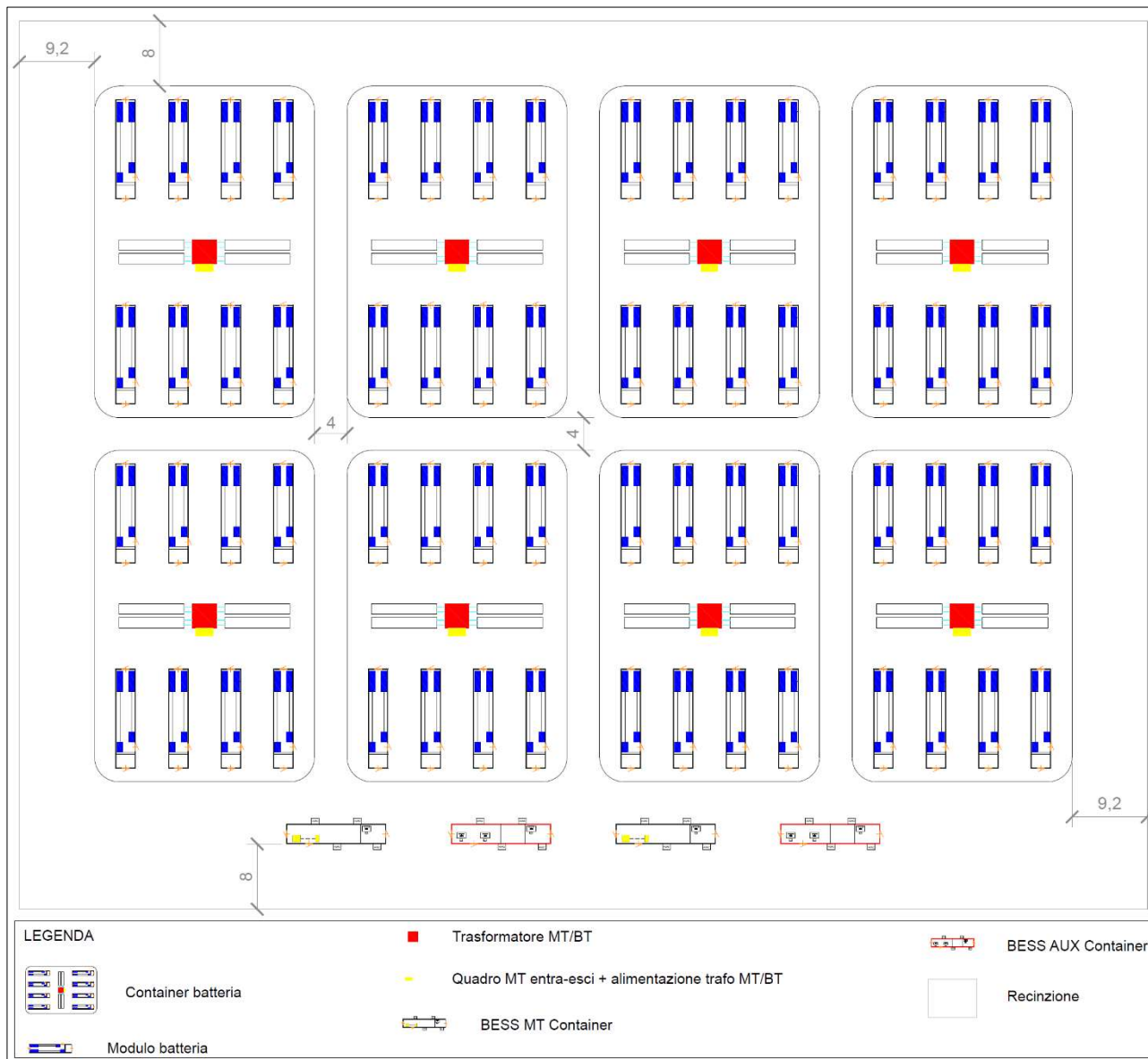
Figura 2.3.2.2: Configurazione dell’impianto BESS
