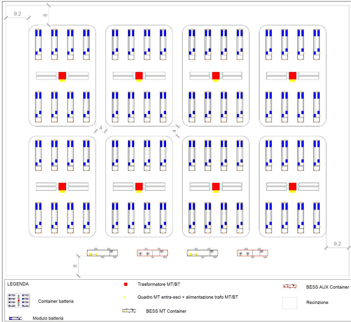
Figura 6.3.2.2: Configurazione dell'impianto BESS
