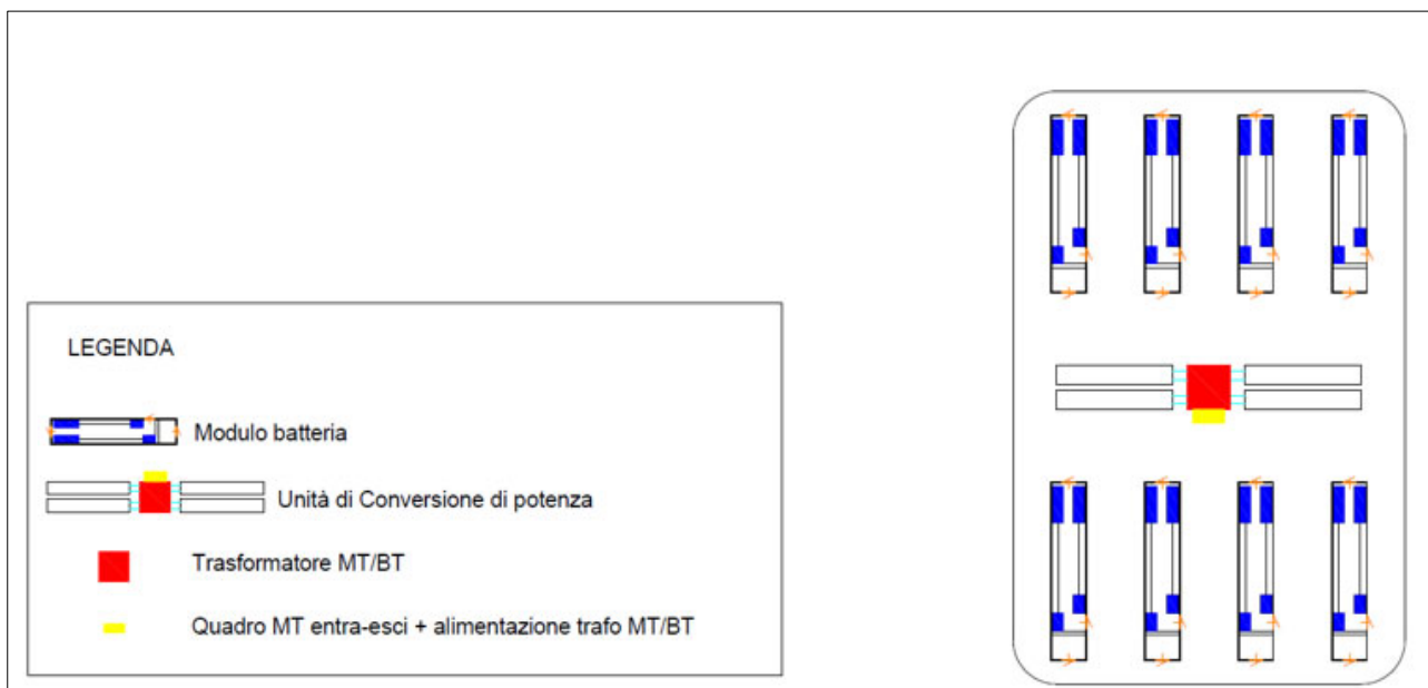
Figura 13.2: Unità base da 4 MW del BESS
