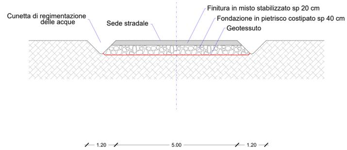
SEZIONE TIPO-SEZIONE IN RILEVATO\_SCALA 1:50
