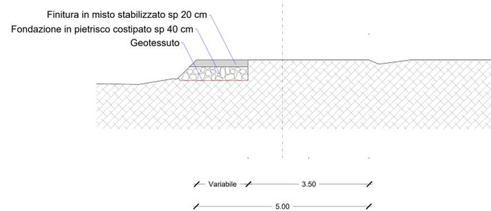
SEZIONE TIPO-ADEGUAMENTO VIABILITA' ESISTENTE\_SCALA 1:50
