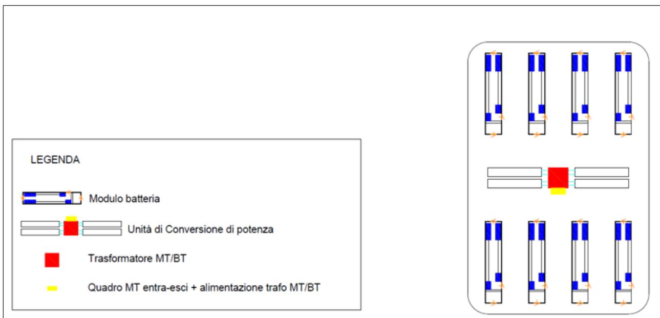
**Figura 8.2:** Unità base da 4 MW del BESS
