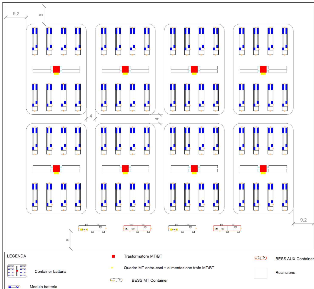
Figura 2.3.2.2: Configurazione dell'impianto BESS
