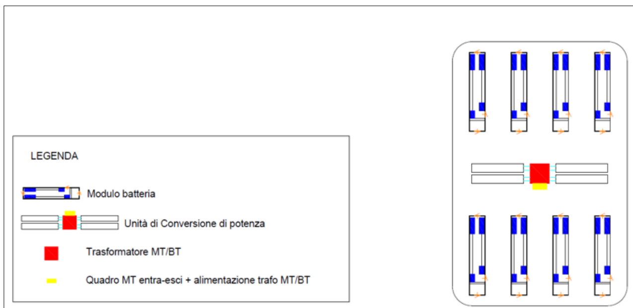
Figura 5.4.1: Unità base da 4 MW del BESS (il contributo di potenza al punto di connessione di ogni unità si ottiene replicando le 8 unità da 3,825 MW per una potenza totale di 30,6 MW)
