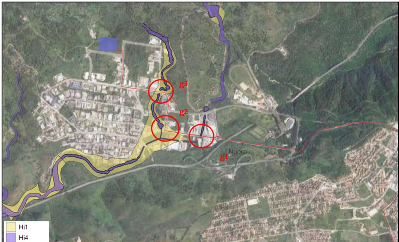
**Figura 5.1.8:** Interferenze **g1, g2, g3** della linea AT con aree a pericolosità Hi1 (g1: Riu Mattaedu) e Hi4 (f2)
