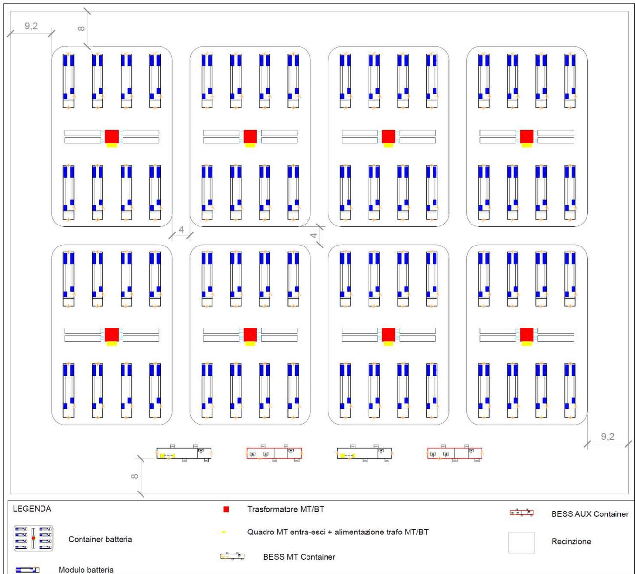
**Figura 2.3.2.2:** Configurazione dell'impianto BESS
