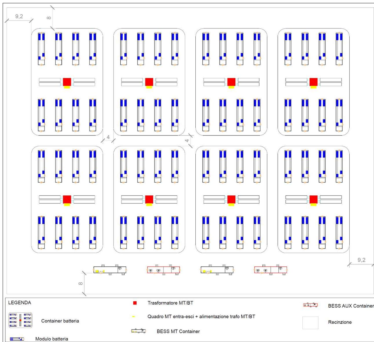
**Figura 2.3.2.2:** Configurazione dell'impianto BESS
