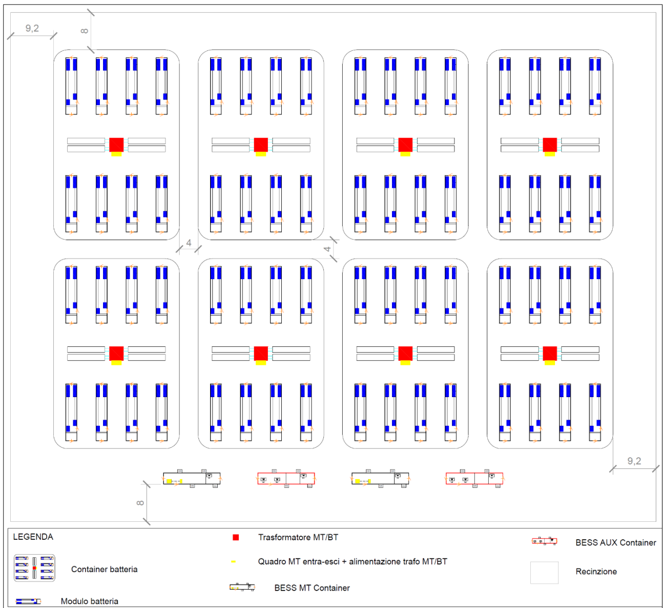
Figura 5.3.2.1: Configurazione dell’impianto BESS
