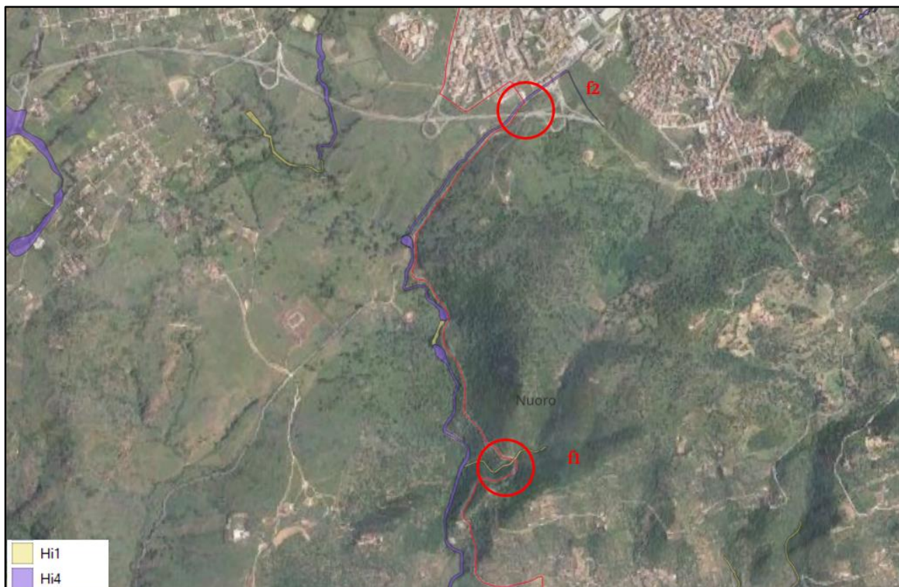
Figura 7.1.7.7: Interferenze f1, f2) della linea AT con aree a pericolosità Hi1 (f1) e Hi4 (f2)
