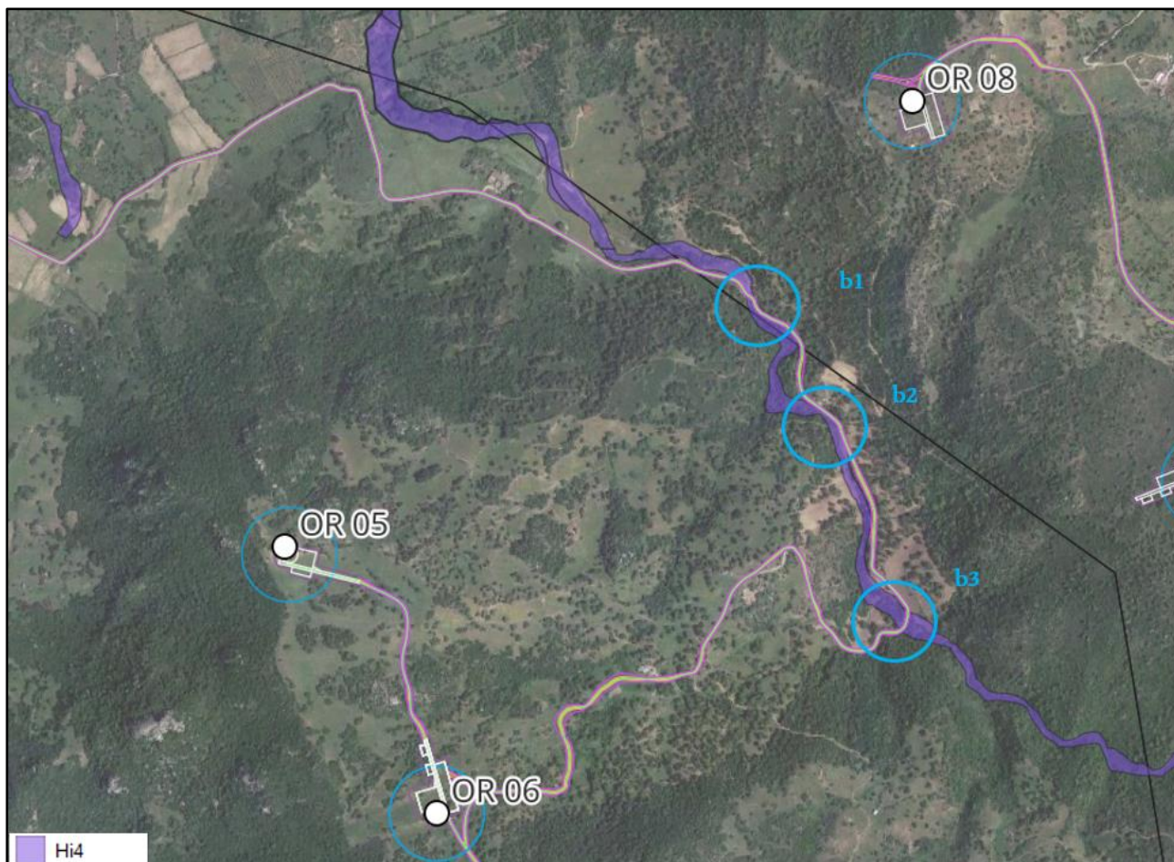
Figura 7.1.7.3: Interferenze b1, b2, b3) della linea MT con aree a pericolosità Hi4
