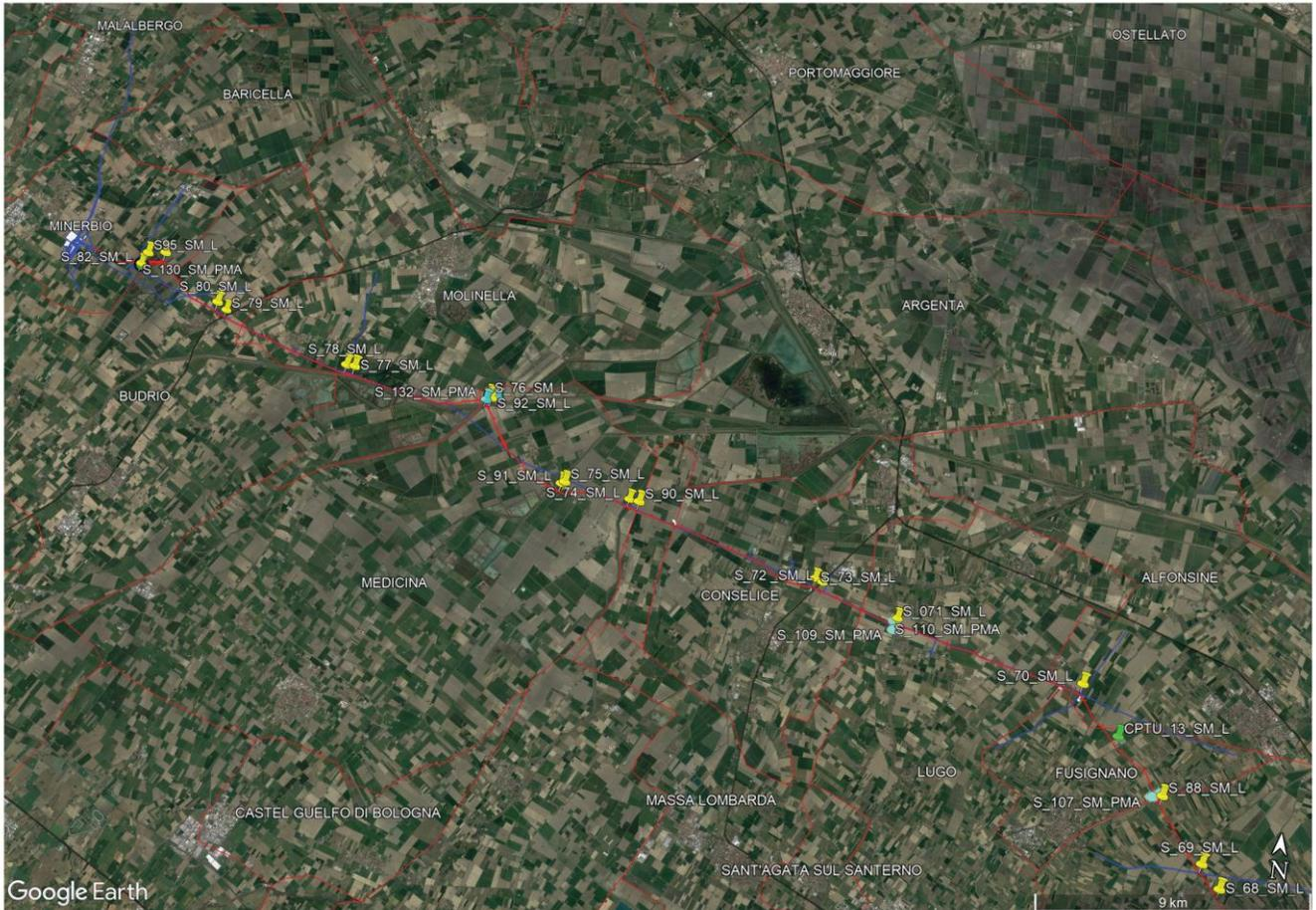
**Figura 4-9: Ubicazione sondaggi e prove CPTU Tratto 95-140km (in rosso tracciato di progetto).**
