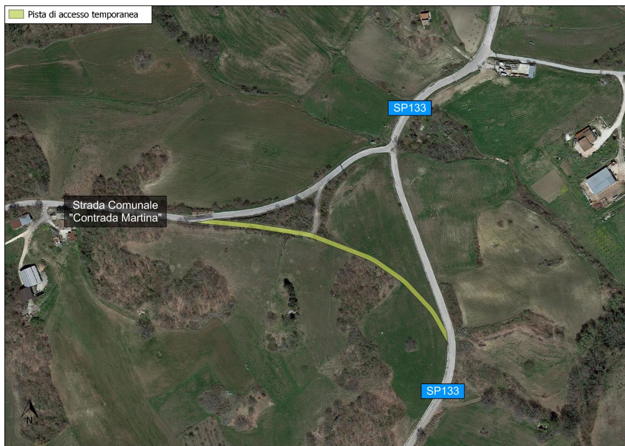
Figura 5 - Pista di accesso temporanea all'impianto in fase di cantiere.
