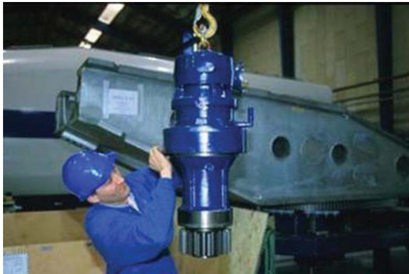
Figura 7: Motori di giro riduttori
