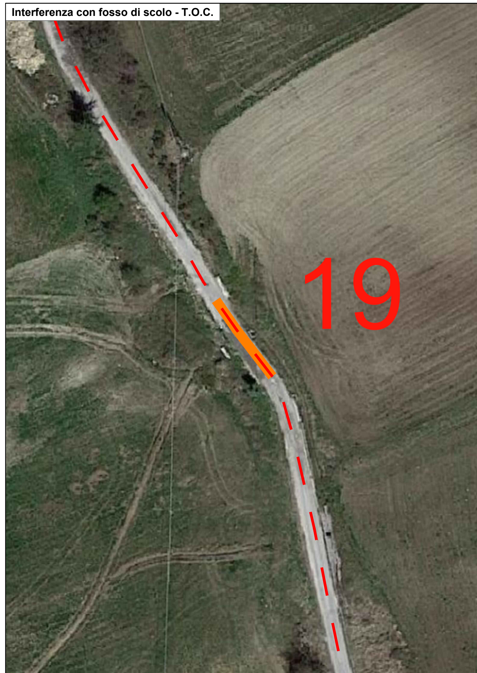
Interferenza con fosso di scolo - T.O.C.
