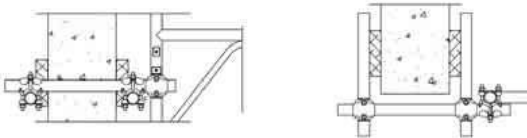
Esempio di ancoraggio "a cravatta"
