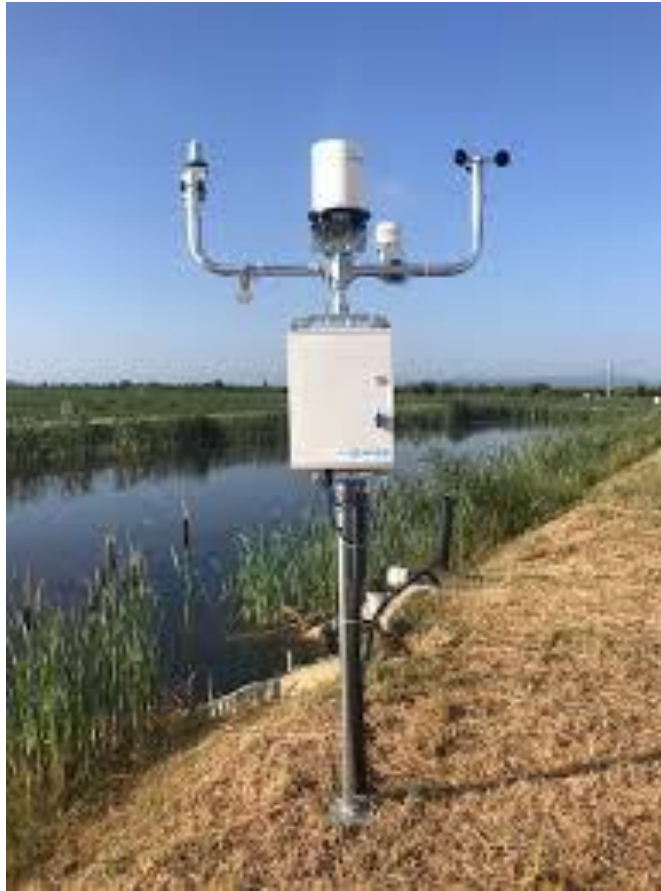
Figura 5 - Esempio di stazione meteoclimatica multi-parametrica
