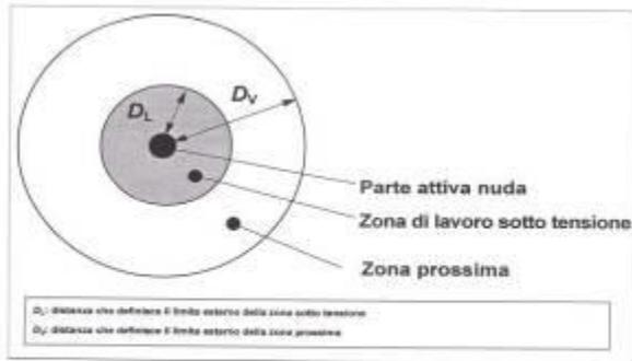
Figura 1 – Distanze in aria e zone per procedure di lavoro
