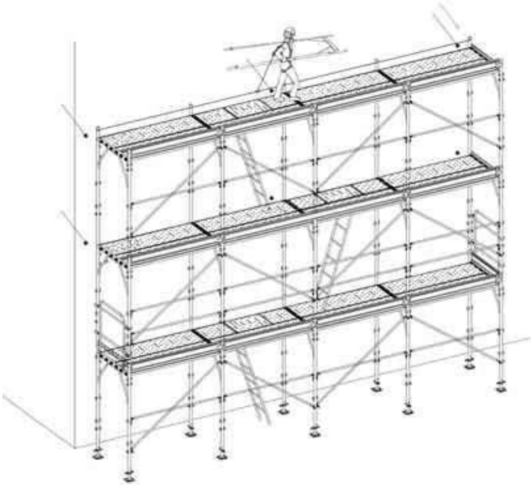
*montaggio dei successivi livelli: linea di ancoraggio posta al livello del piano di lavoro*
