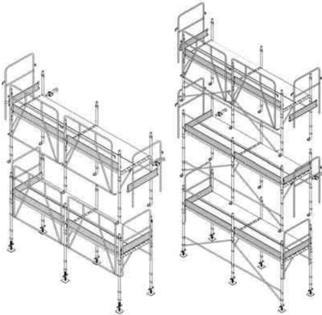
*Fasi di montaggio dal basso del ponteggio con parapetto di protezione collettivo:*
