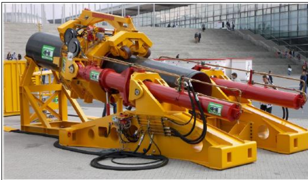
Fig.7.3/D: Pipe Thruster, presentata Hannover nel 2006 [Herrenknecht]
