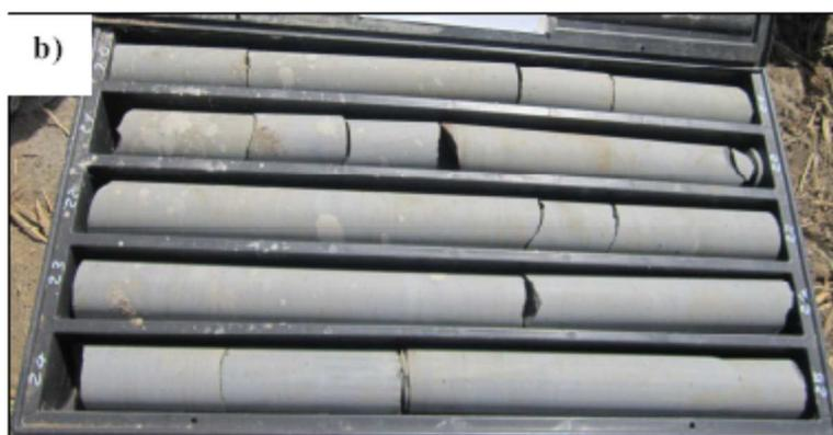
Figura 4.4.8 - Tefrite in facies inferiore che si presenta completamente integra all'estrazione dal carotiere doppio
