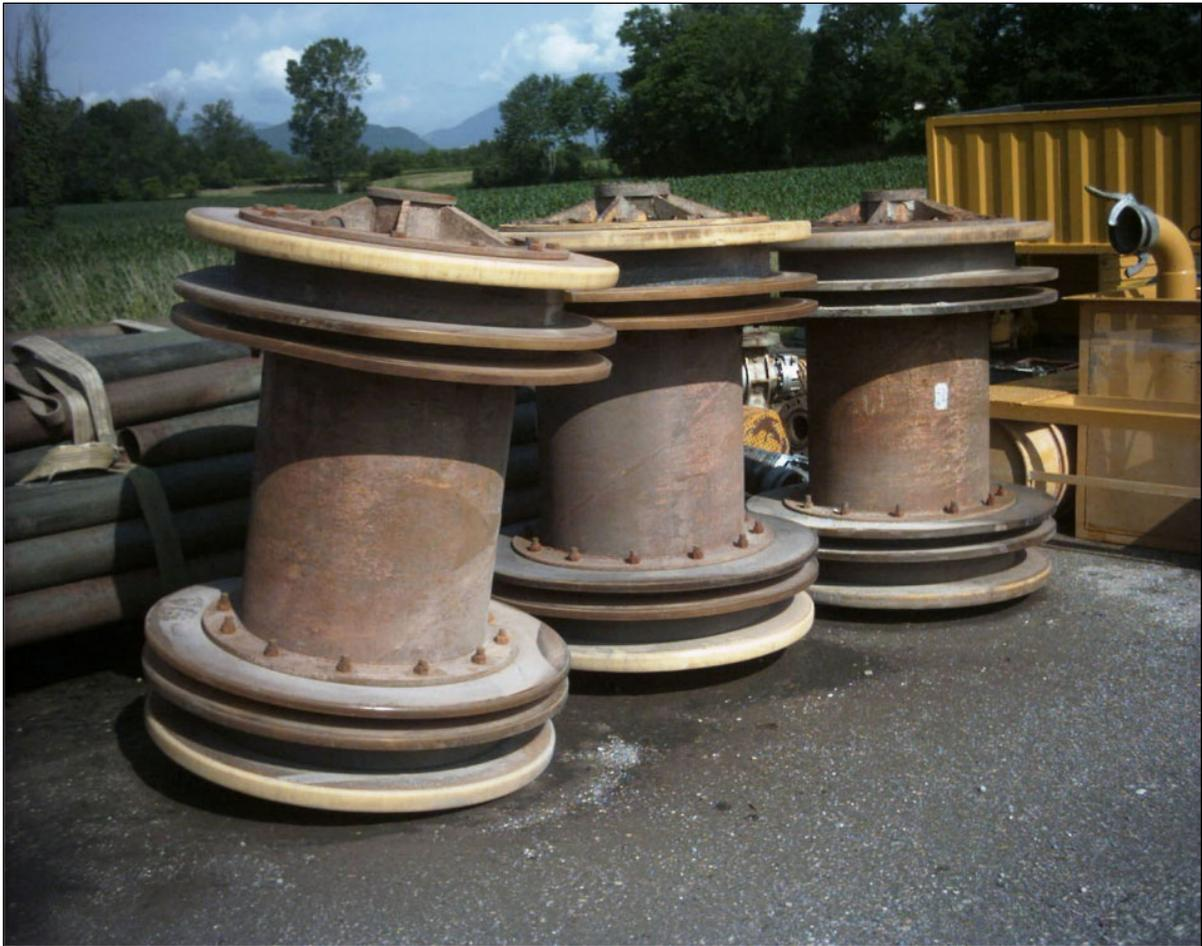
**Fig. 2.2/B “pig per collaudo idraulico”**
