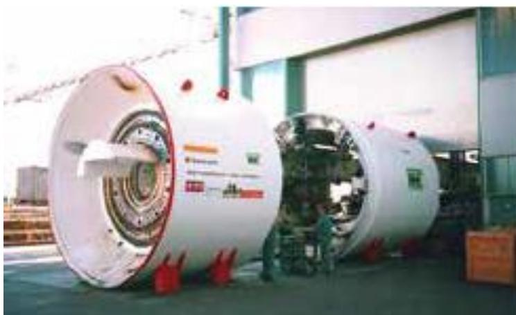
**Figura 8-C: Immagine di una TBM scudata**
