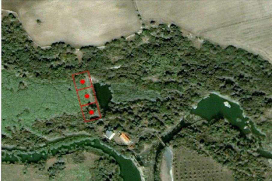
Le perforazioni saranno eseguite a carotaggio continuo con tecnica a rotazione utilizzando carotieri semplici e carotieri doppi.
