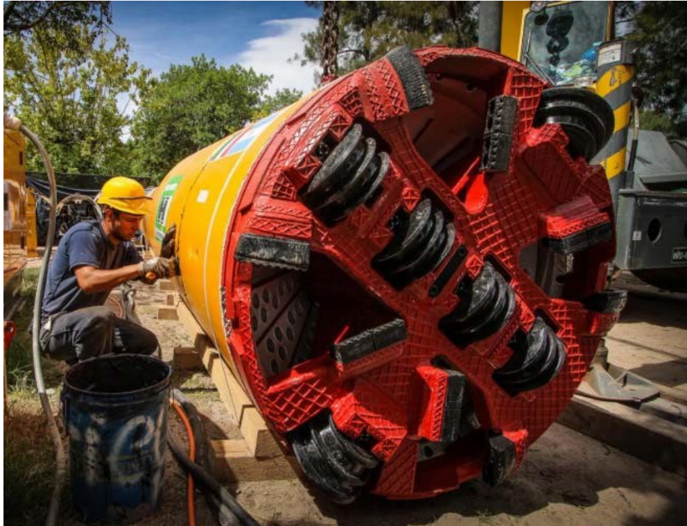
Fig. 4.2/A: Esempio di testa fresante di microtunnel
