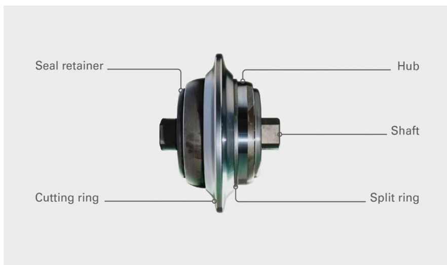
Fig. 4.2/C: Esempio di disco tagliente operante sulla testa della fresa del microtunnel (dal sito di Herrenknecht,)
