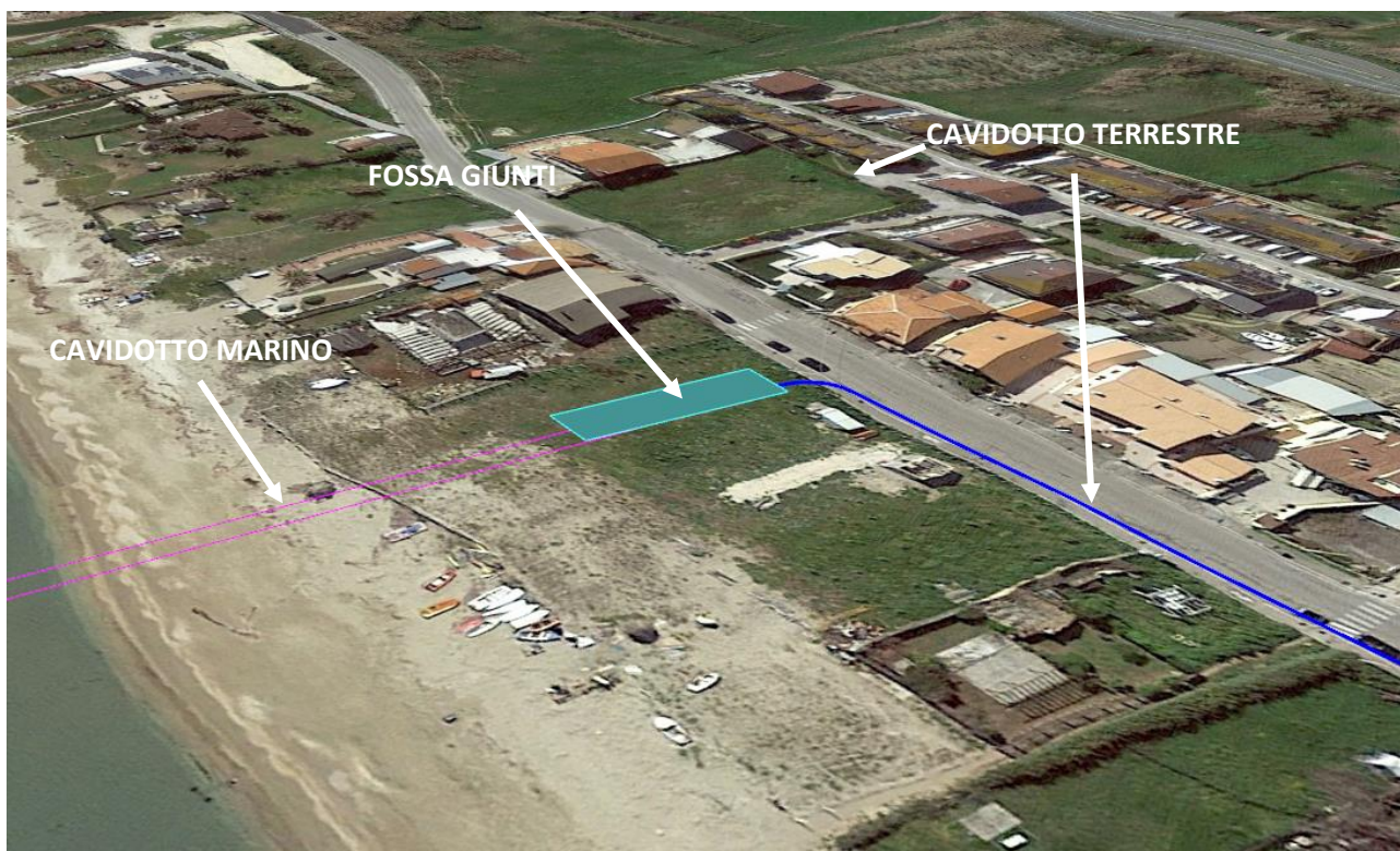
Figura 17 - Punto di sbarco a terra sulla spiaggia di Postilli (frazione del comune di Ortona)
