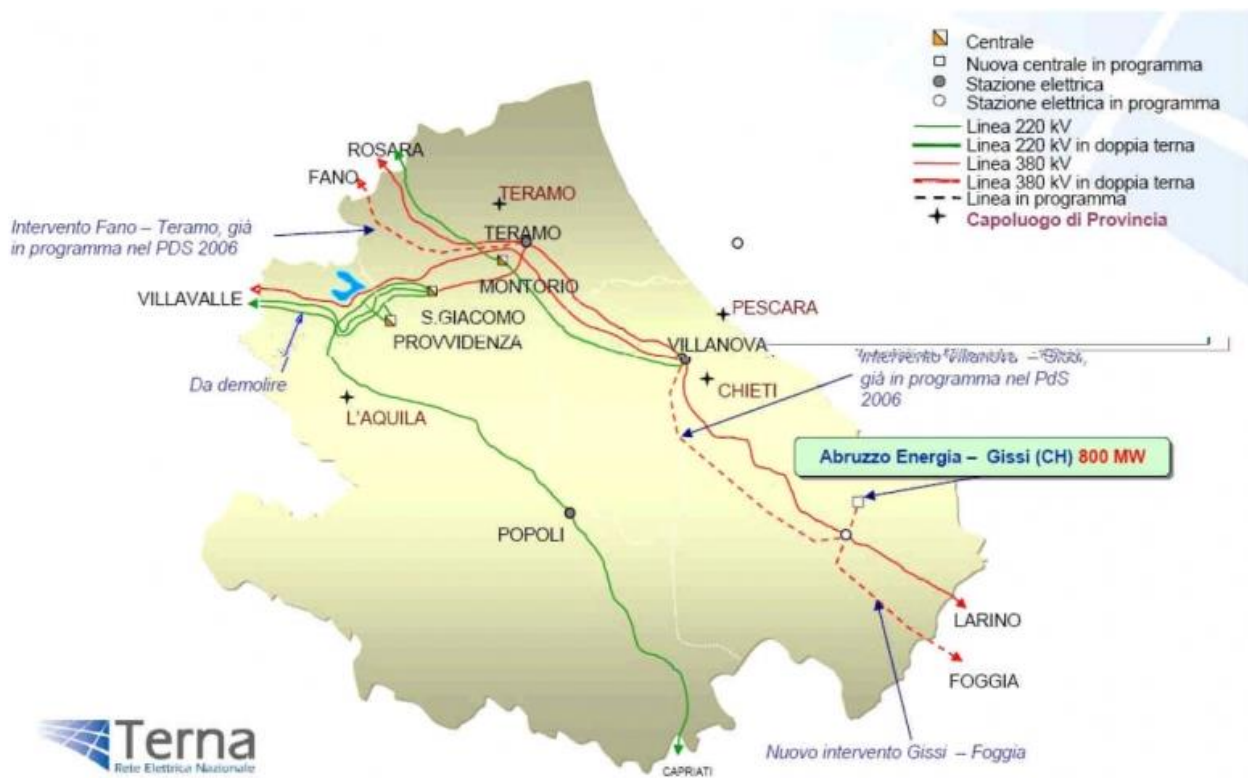
Figura 6 - Inquadramento rete AT ed MT della regione Abruzzo
