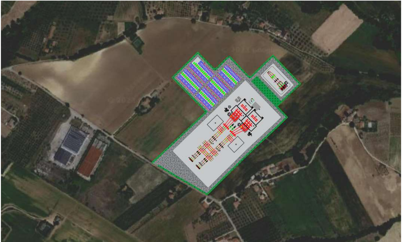
Figura 18 - Layout del sistema di accumulo BESS (Battery Energy Storage System), STC2 e SU su ortofoto
