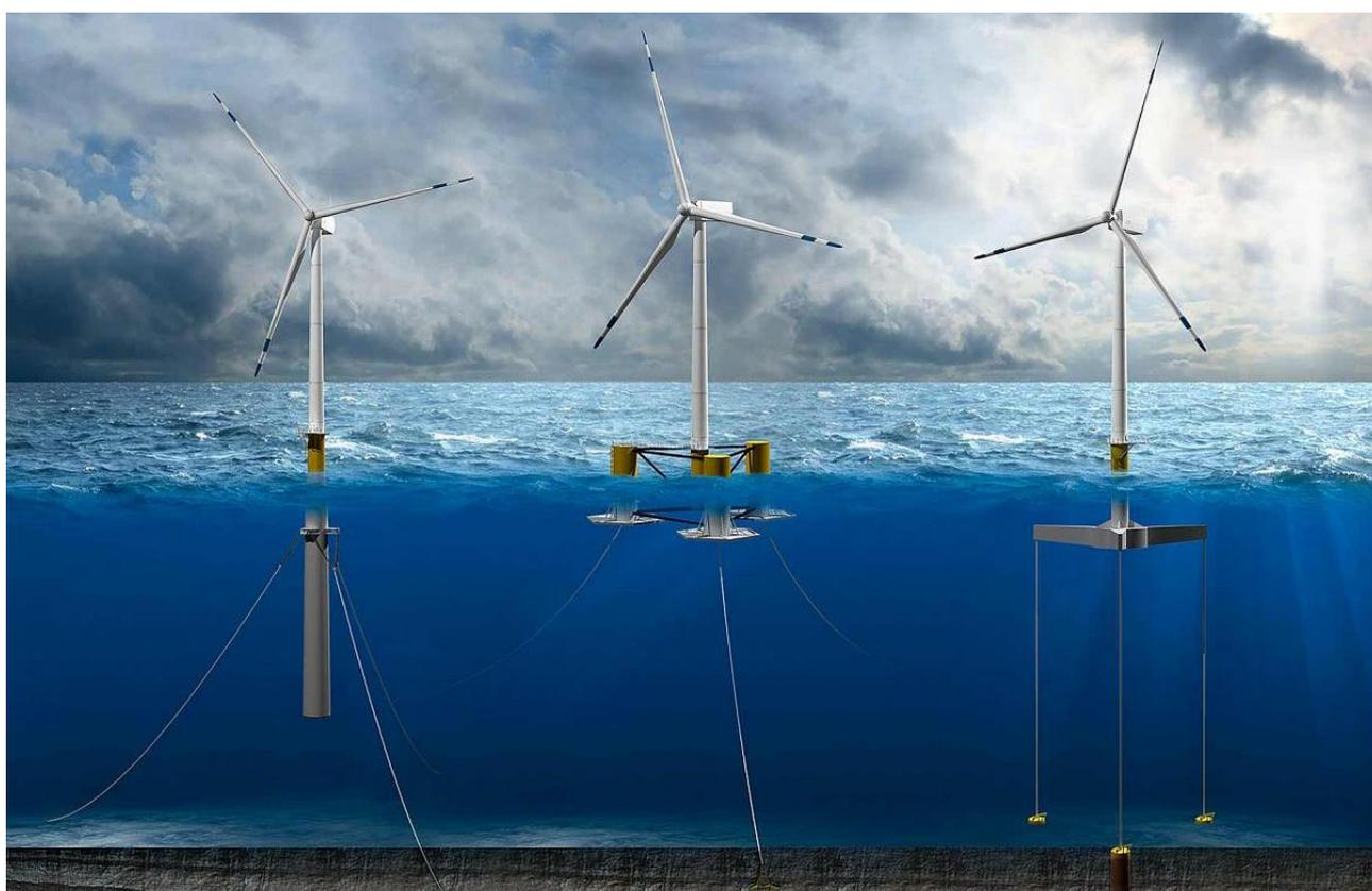
*Figura 9 - Diverse tipologie di strutture galleggianti*
