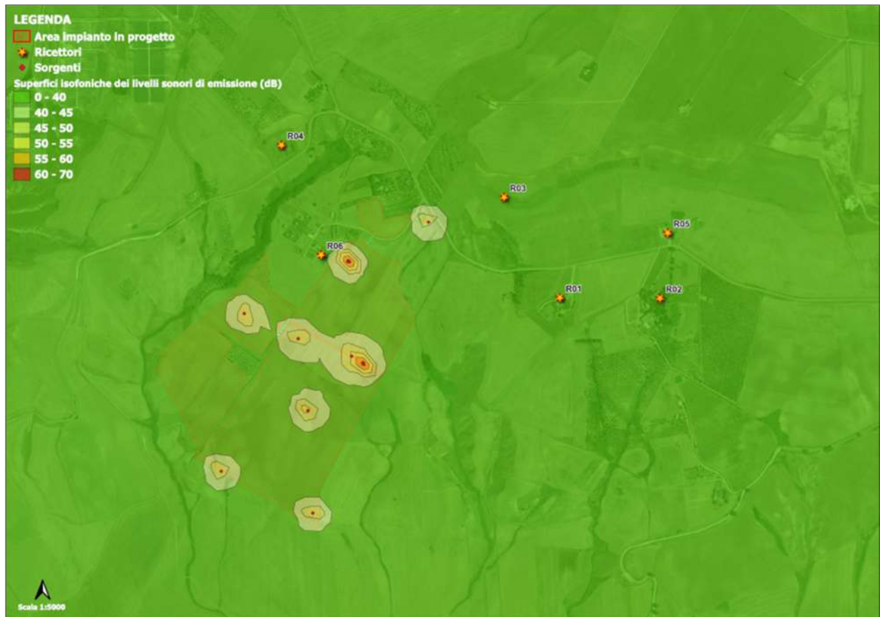
Figura 8-1 – Stralcio cartografico superfici isofoniche dei livelli sonori di emissione (dB) – Impianto agro-voltaico in progetto
