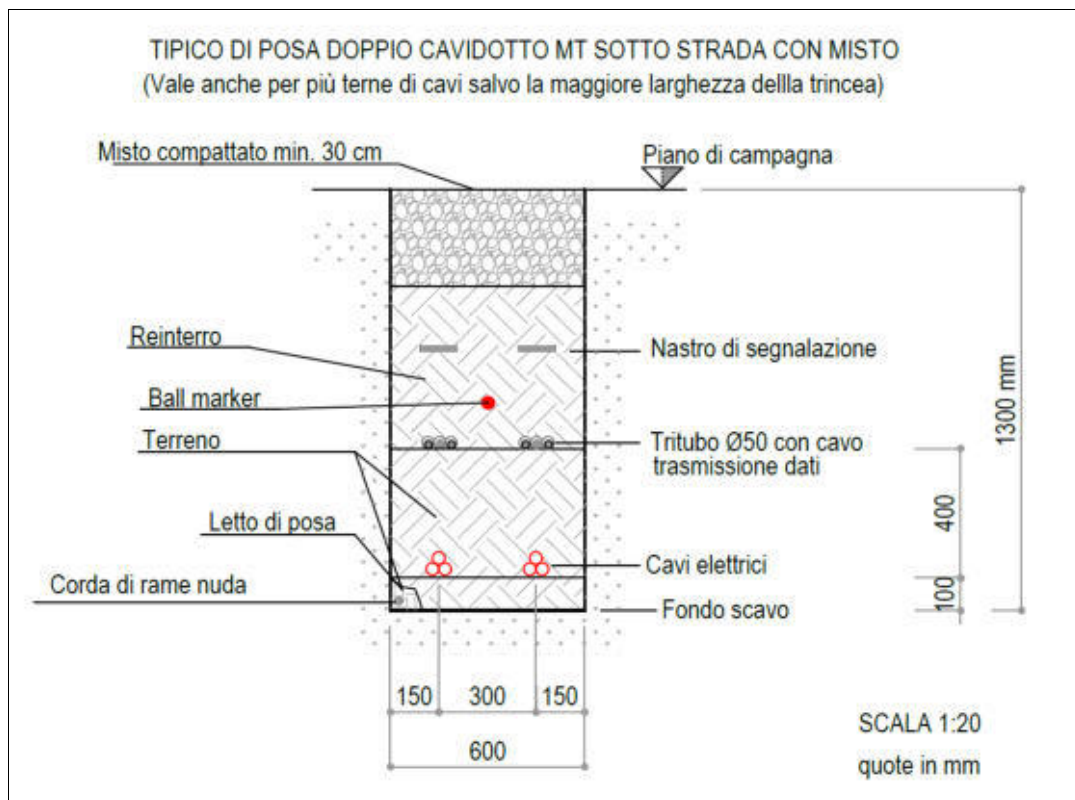
Figura 78 Tipico posa cavidotto su sterrato con 2 terre
