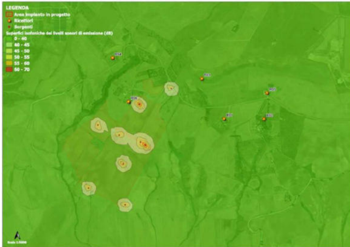
Figura 95 - Stralcio cartografico superfici isofoniche dei livelli sonori di emissione (dB) – Impianto agrivoltaico in progetto
