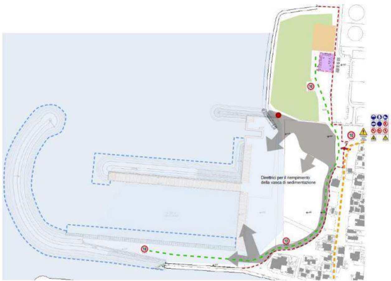
Figura 4 - Darsena pescherecci. Organizzazione del cantiere di costruzione
