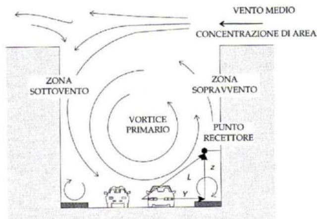
Figura 46 - Caratteristiche geometriche e di circolazione dell'aria in un canyon urbano
