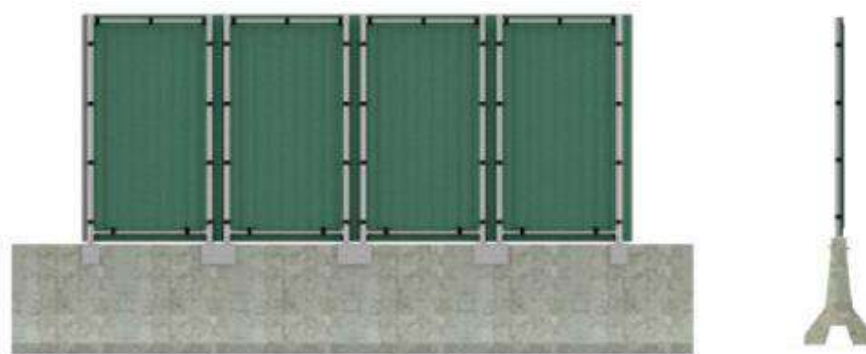
Figura 72 – Esempio barriere mobili installate su new jersey
