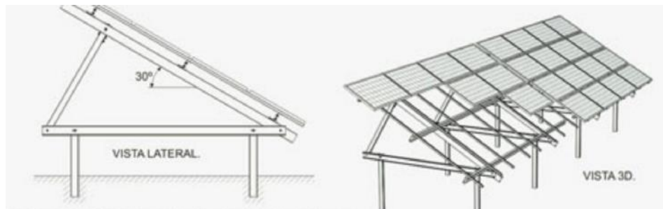
Figura 37 - Strutture fisse 4H
