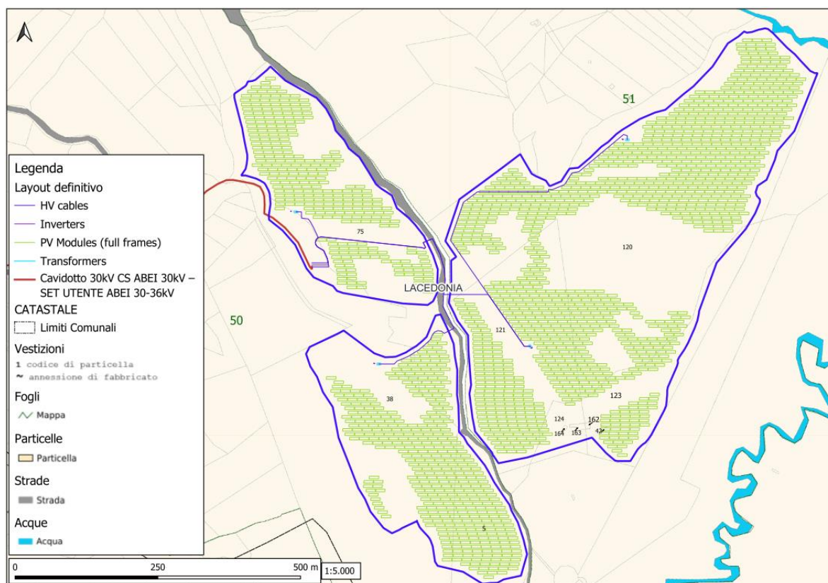
Figura 2 - Inquadramento dell'Area Parco su Catastale in scala 1:5.000.
