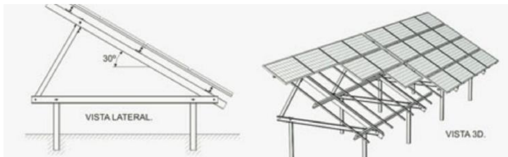
Figura 13 - Strutture fisse 4H
