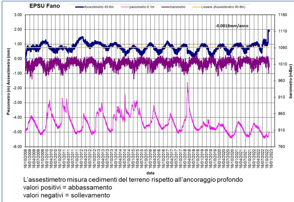
**Figura 11B - Stazione EPSU di Fano: misure piezometriche-assestimeriche e barometriche.**
