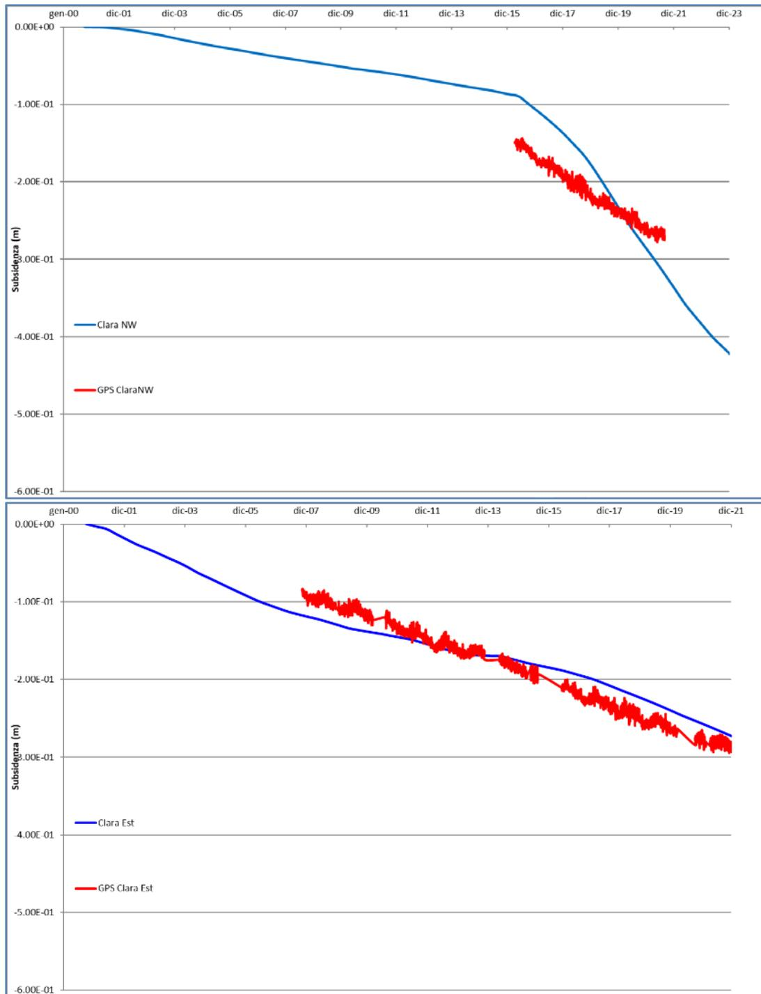
**Figura 15 - Clara NW e Clara Est: andamento della subsidenza misurata (CGPS in p.ma) vs. modello (scenario FD).**
