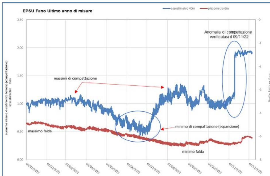
**Figura 12B - Stazione EPSU di Fano: misure piezometrico-assestimeriche, ultimo anno di dati.**
