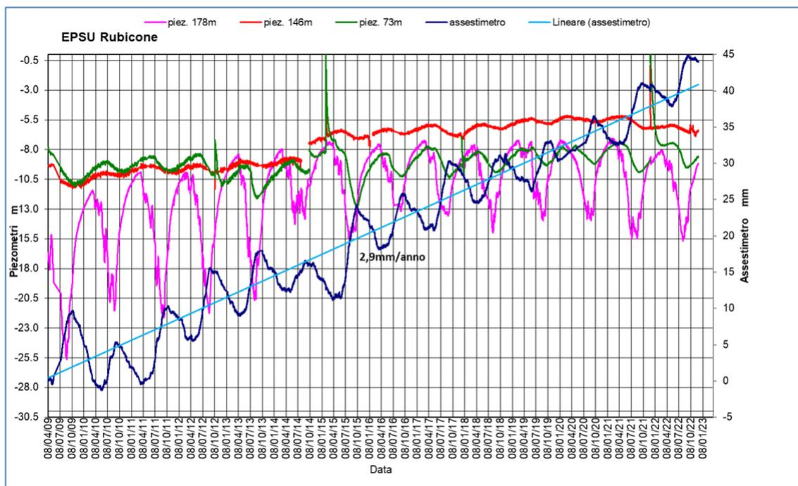
**Figura 7B - Stazione EPSU di Rubicone: misure piezometriche-assestimetriche.**
