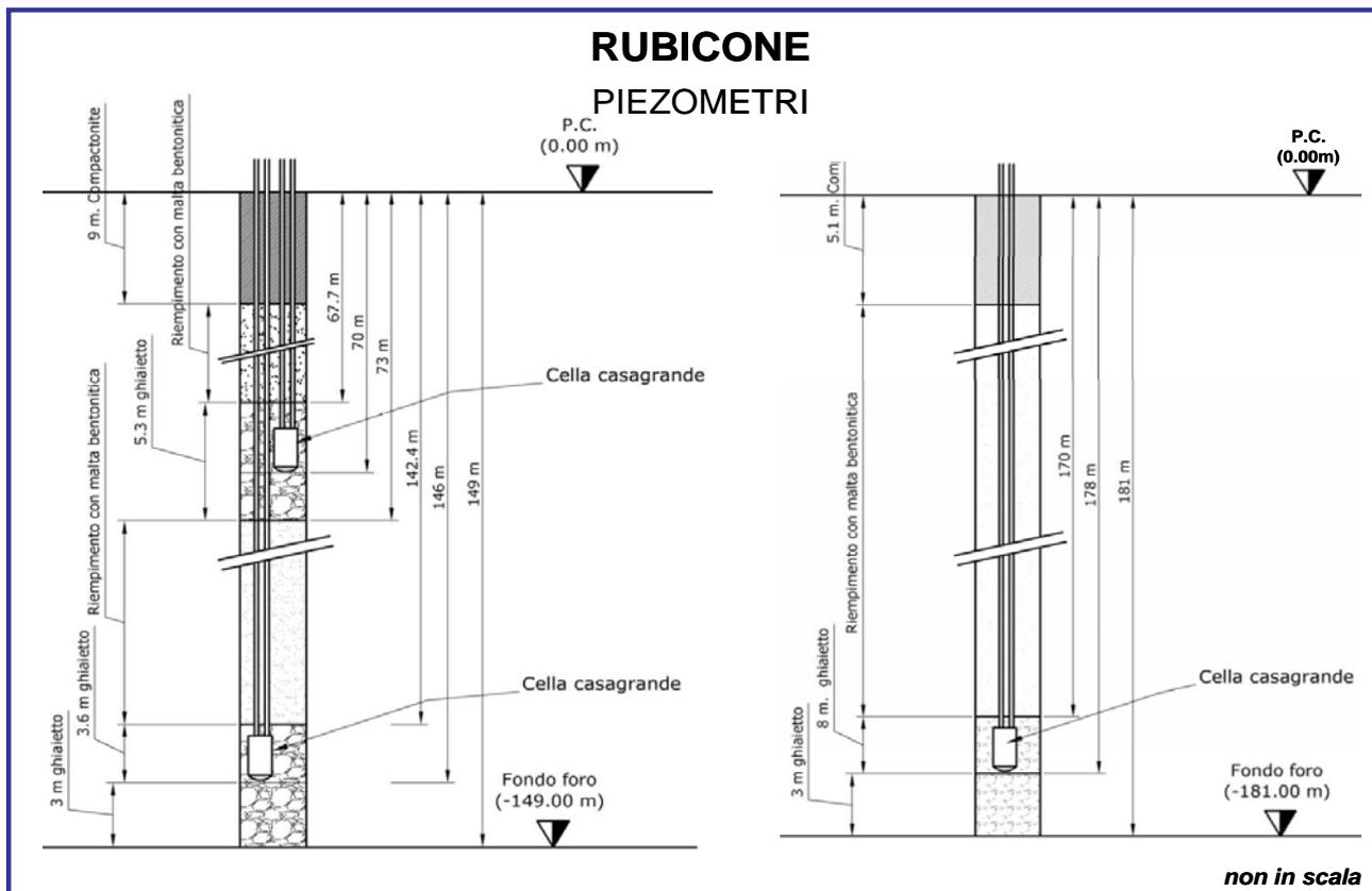
Figura 3B - Schema della stazione EPSU di Rubicone
