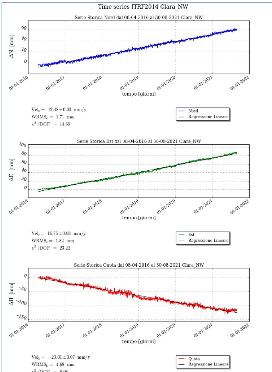
**Figura 12 - Campo di Clara Est-NW: serie storiche di misure CGPS (stazione CGPS installata sulla p.ma Clara NW)**
