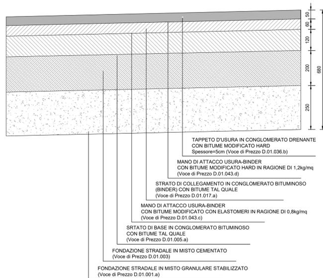
**PARTICOLARE PACCHETTO PAVIMENTATO SVINCOLI ROTATORIE E ASSI SECONDARI**
