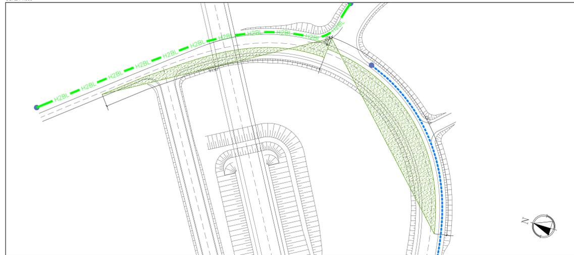
VISIBILITA' INTERSEZIONE ASSE PRINCIPALE - VIADOTTO RAMPA IL
