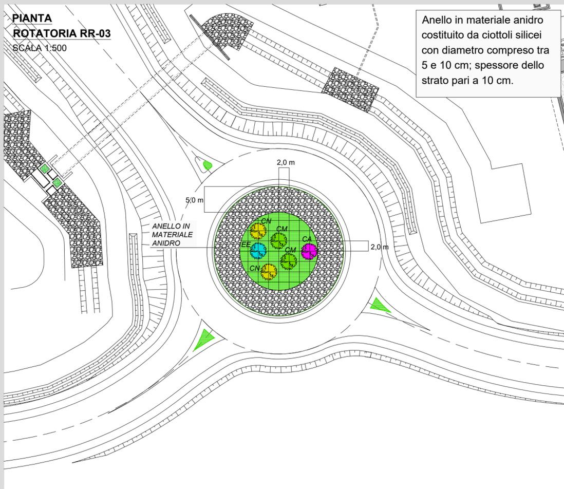
Anello in materiale anidro costituito da ciottoli silicei con diametro compreso tra 5 e 10 cm; spessore dello strato pari a 10 cm.
