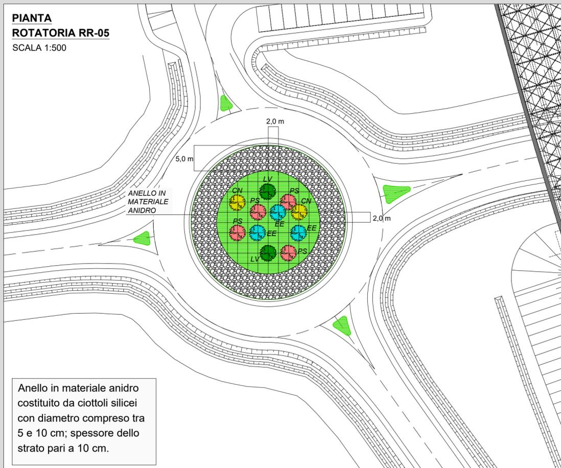
Anello in materiale anidro costituito da ciottoli silicei con diametro compreso tra 5 e 10 cm; spessore dello strato pari a 10 cm.
