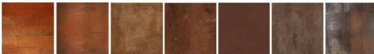
FIGURA 3-2 GRADAZIONI DI ACCIAIO CORTEN PER IMPALCATI
