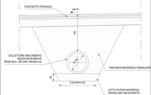
**SEZIONE E-E CONDOTTA DI SCARICO DN 200mm**
