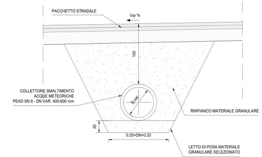
SEZIONE E-E - LONGITUDINALE CONDOTTA DI SCARICO
