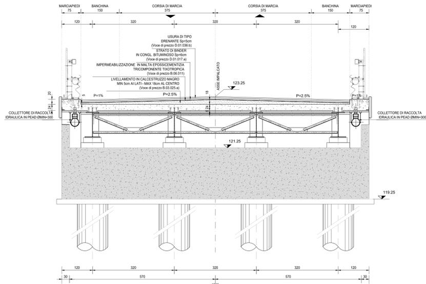
**SEZIONE IN PILA 02**
