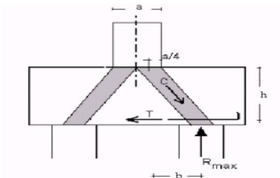
Per la verifica della fondazione è necessario per prima cosa stabilire la larghezza di zattera di fondazione competente al singolo palo, da assumere per il meccanismo resistente a tirante-puntone. Si ottiene diffondendo il carico trasmesso dal palo secondo delle isostatiche a 45°, ed è pari a  $l = 4,95 \text{ m}$ , come mostrato delle immagini successive:
