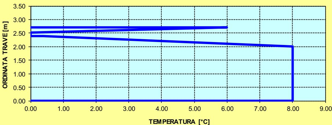
**DEFINIZIONE DEL PROFILO DI TEMPERATURA PER  $\Delta T$  POSITIVO (SOLETTA CALDA)**
