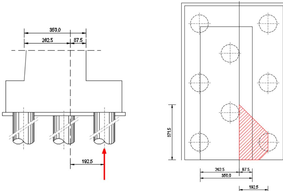
Di seguito si assume quindi un sistema a tirante-puntone isolato dal resto del plinto e di larghezza pari a  $l = 3,715 \text{ m}$ , nel quale il tirante è costituito da **38Ø26** (Area: **201,75 cm<sup>2</sup>**).
