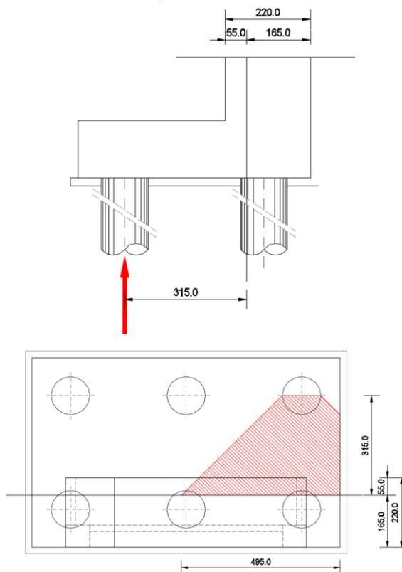
Di seguito si assume quindi un sistema a tirante-puntone isolato dal resto del plinto e di larghezza pari a  $l = 4,95 \text{ m}$ , nel quale il tirante è costituito da **130Ø26** (Area: **690,21 cm<sup>2</sup>**).
