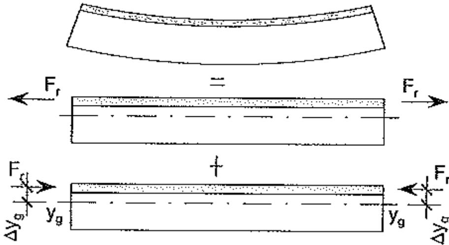
Trattandosi di un impalcato a struttura continua, e dunque iperstatica, all'effetto del ritiro precedentemente descritto (effetto isostatico), occorre sommare un effetto dovuto alla deformazione impedita per la presenza dei vincoli (effetto iperstatico). Tale effetto viene attribuito alla struttura applicando, nel modello di calcolo, alle estremità delle travi un momento flettente uguale al momento di trasporto isostatico.
