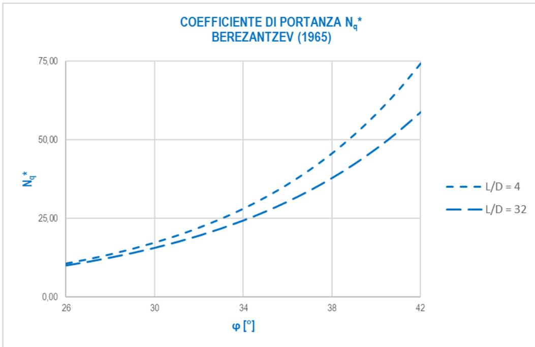
Considerato un terreno alla base con angolo di attrito pari a  $31,70^\circ$  e un rapporto  $L/D = 26,00/1,20 = 21,67$ , è stato determinato un valore del coefficiente di portanza alla punta pari a  $N_q^* = 18,28$ .
