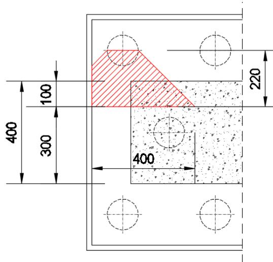
Di seguito si assume quindi un sistema a tirante-puntone isolato dal resto del plinto e di larghezza pari a  $l = 4,00 \text{ m}$ , nel quale il tirante è costituito da **41Ø26** (Area: **217,68 cm<sup>2</sup>**).
