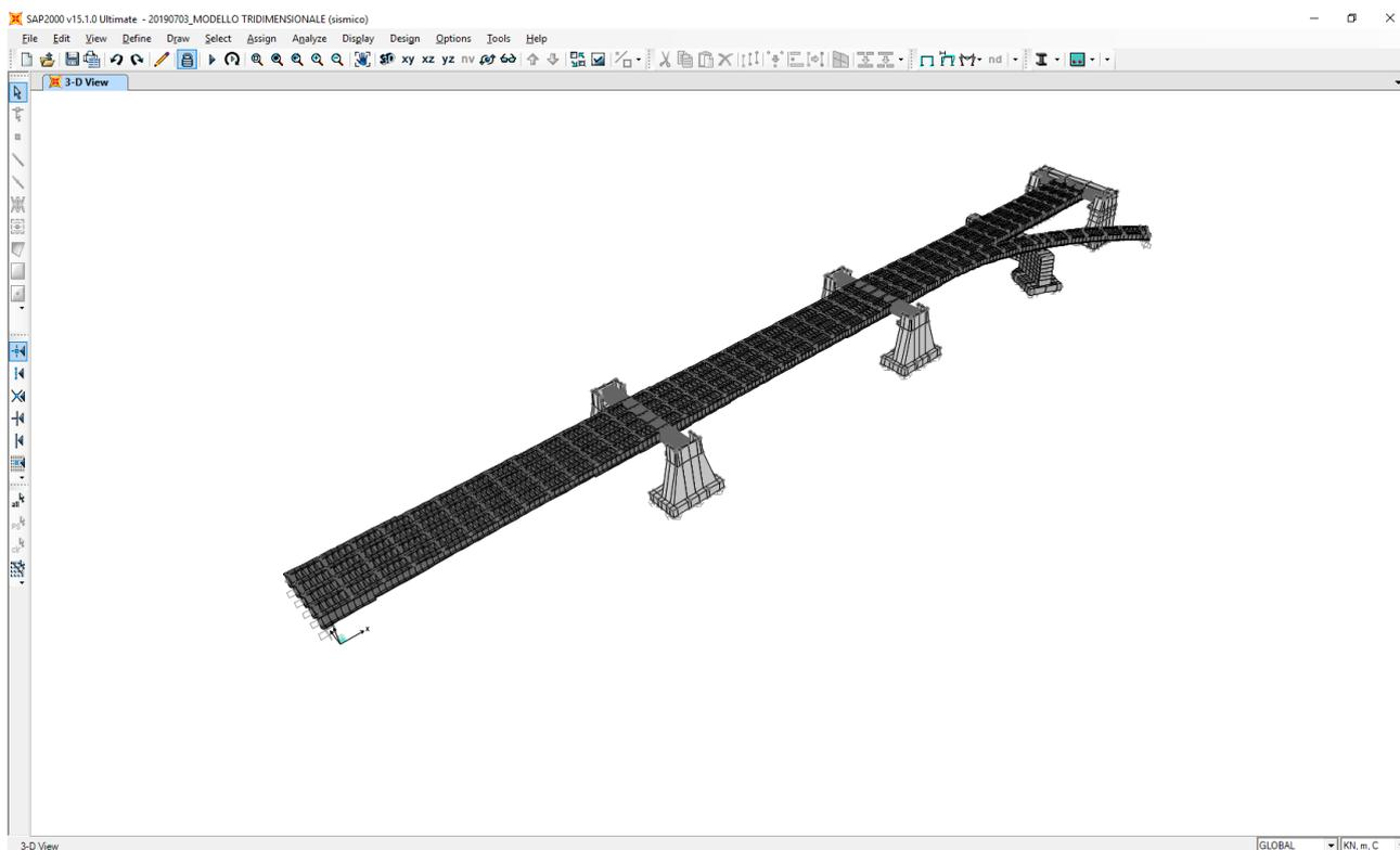
Le pile 1, 2 e la spalla B, al fine di rispettare le esatte geometrie e il corretto posizionamento delle masse, sono state modellate mediante elementi tridimensionali tipo “solid”, mentre la pila 3 è stata modellata mediante elementi bidimensionali tipo “shell”.
