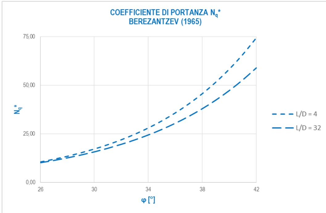
Considerato un terreno alla base con angolo di attrito pari a  $31,70^\circ$  e un rapporto  $L/D = 32,00/1,20 = 26,67$ , è stato determinato un valore del coefficiente di portanza alla punta pari a  $N_q^* = 17,93$ .
