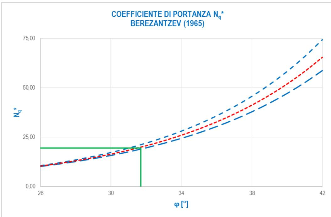
Considerato l’utilizzo del metodo di Berezantzev “ridotto” per i pali di grande diametro (cautelativo), non è stata presa in considerazione la correlazione di Kishida per i pali trivellati.
