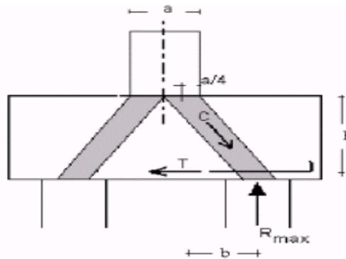
Per la verifica della fondazione è necessario per prima cosa stabilire la larghezza di zattera di fondazione competente al singolo palo, da assumere per il meccanismo resistente a tirante-puntone. Si ottiene diffondendo il carico trasmesso dal palo secondo delle isostatiche a 45°, ed è pari a  $l = 4,025 \text{ m}$ , come mostrato delle immagini successive:
