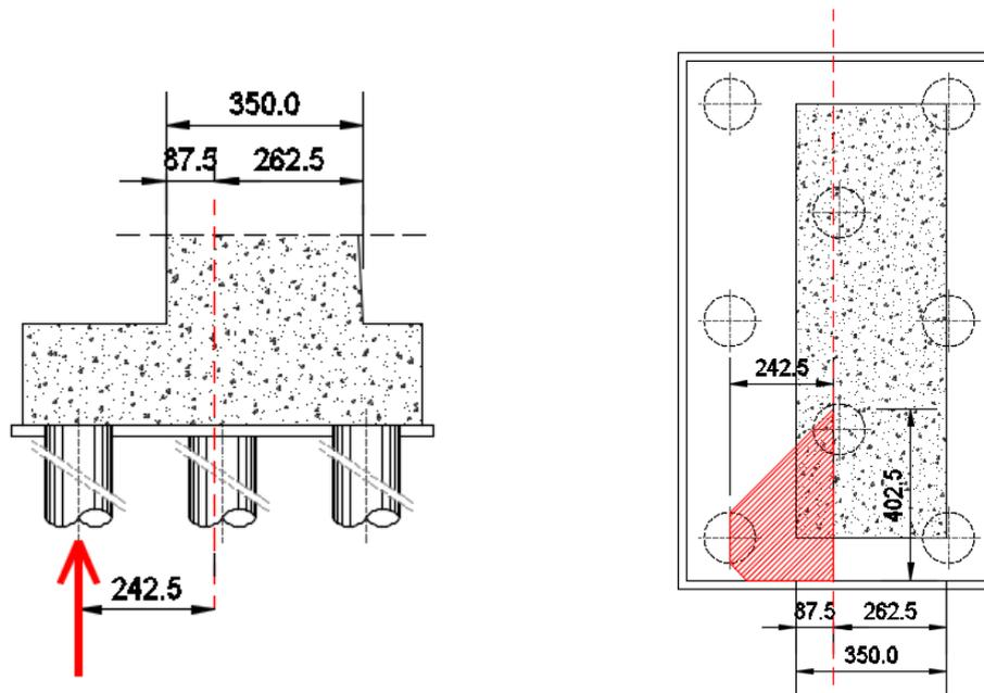
Di seguito si assume quindi un sistema a tirante-puntone isolato dal resto del plinto e di larghezza pari a  $l = 4,025 \text{ m}$ , nel quale il tirante è costituito da  $41\text{Ø}26$  (Area:  $217,68 \text{ cm}^2$ ).
