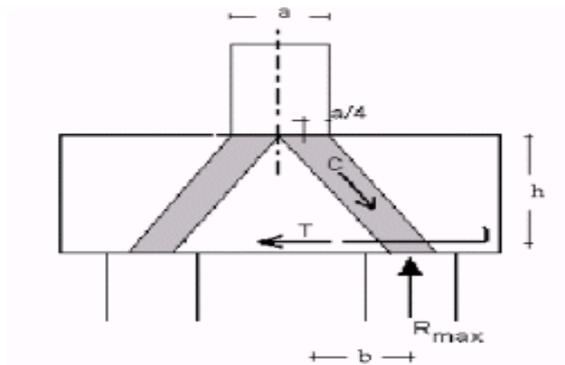
Per la verifica della fondazione è necessario per prima cosa stabilire la larghezza di zattera di fondazione competente al singolo palo, da assumere per il meccanismo resistente a tirante-puntone. Si ottiene diffondendo il carico trasmesso dal palo secondo delle isostatiche a 45°, ed è pari a  $l = 4,00$  m, come mostrato delle immagini successive:
