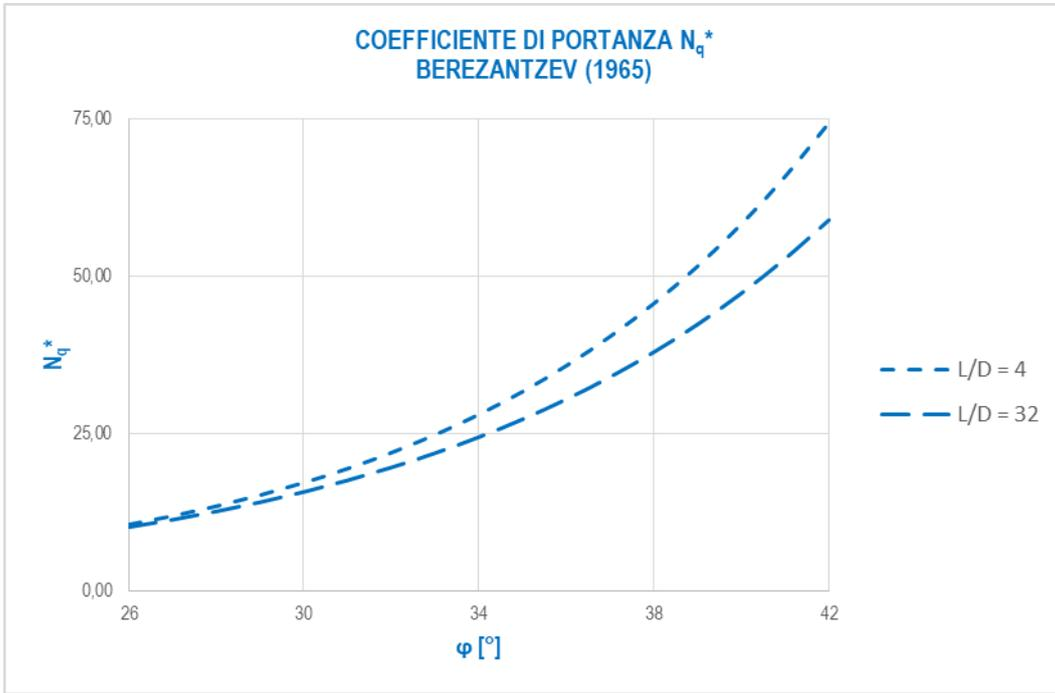
Considerato un terreno alla base con angolo di attrito pari a  $31,70^\circ$  e un rapporto  $L/D = 24,00/1,20 = 26,67$ , è stato determinato un valore del coefficiente di portanza alla punta pari a  $N_q^* = 18,40$ .
