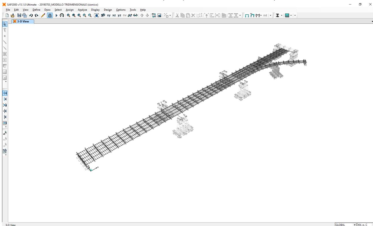
Gli elementi dell'impalcato sono stato tutti modellati mediante elementi monodimensionali tipo "beam".
