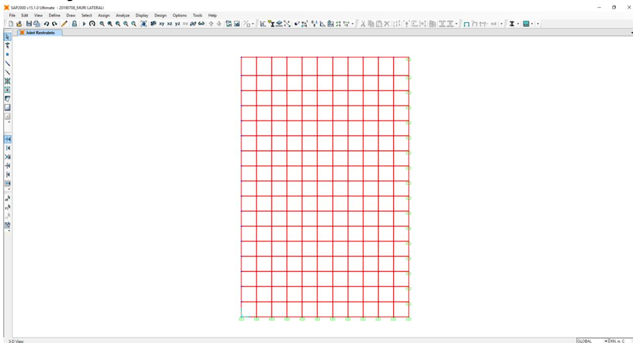
I muri laterali sono stati modellati mediante elementi bidimensionali tipo "shell" con comportamento a "lastra – piastra". Lo schema statico adottato è di piastra incastrata su due lati.
