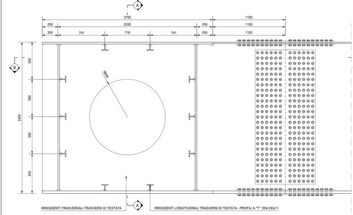
TRASVERSO SPALLA B - SEZIONE A-A
