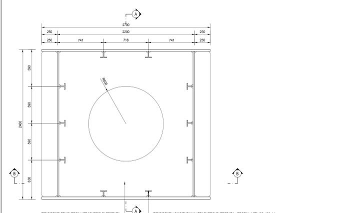
TRASVERSO SPALLA B - SEZIONE B-B
