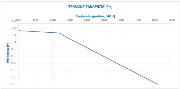
La tensione tangenziale risulta sempre inferiore a 100,00 kPa, nel rispetto dell'assunzione presente nel progetto definitivo.
