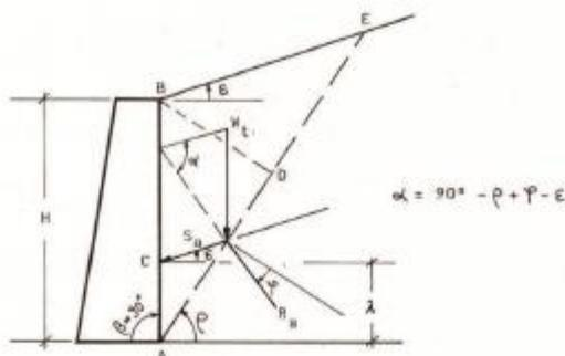
La spinta di Rankine è inclinata dell'angolo  $\varepsilon$  rispetto alla orizzontale per C e dista  $H/3$  dal piede. Per determinare  $S_{ar}$  occorre conoscere il **coefficiente di spinta attiva di Rankine**:
