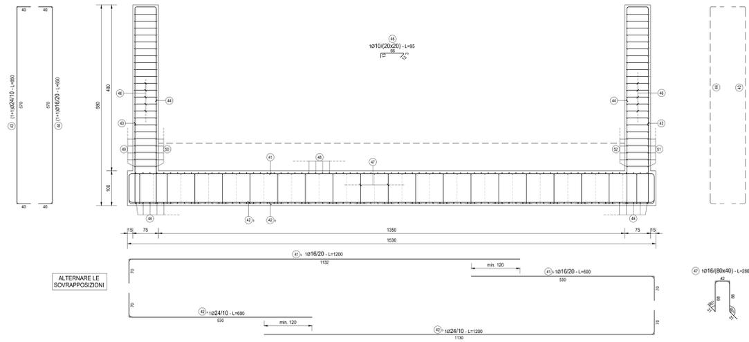
**DETTAGLIO RINGROSSO - SEZIONE LONGITUDINALE**
