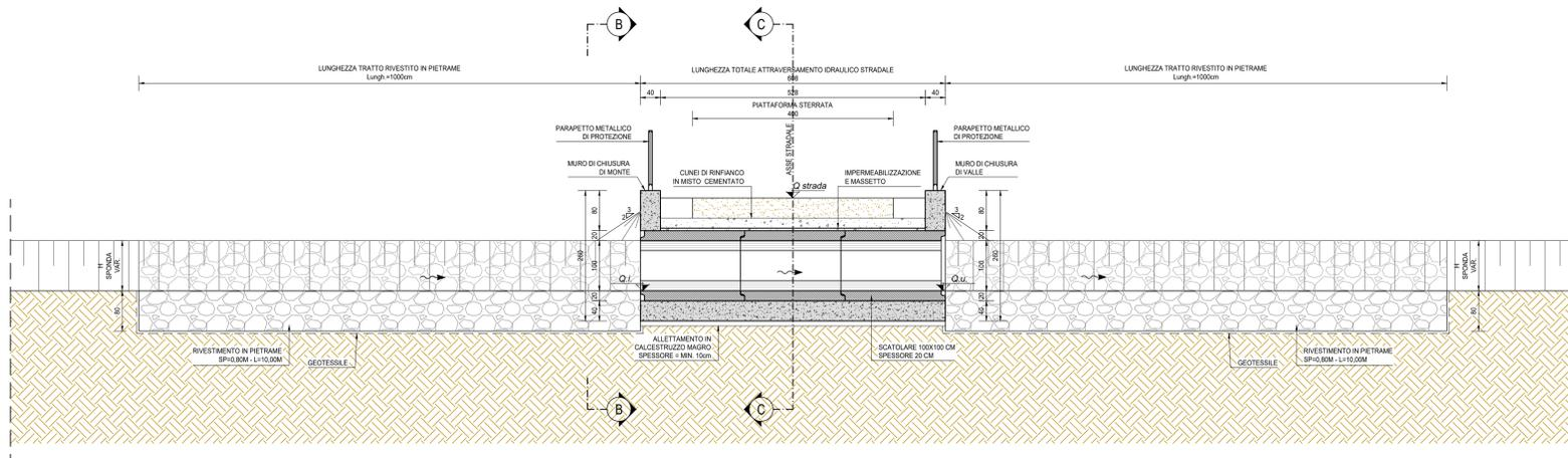
SEZIONE TRASVERSALE IN ASSE STRADA (SEZIONE C-C)
