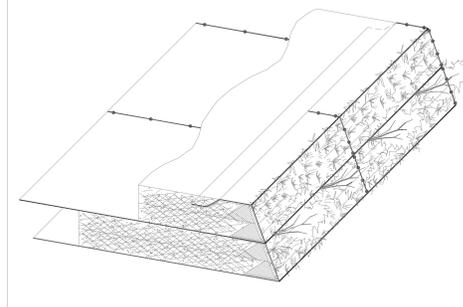
**SEZIONE MURO IN TERRA RINFORZATA IN DX**
