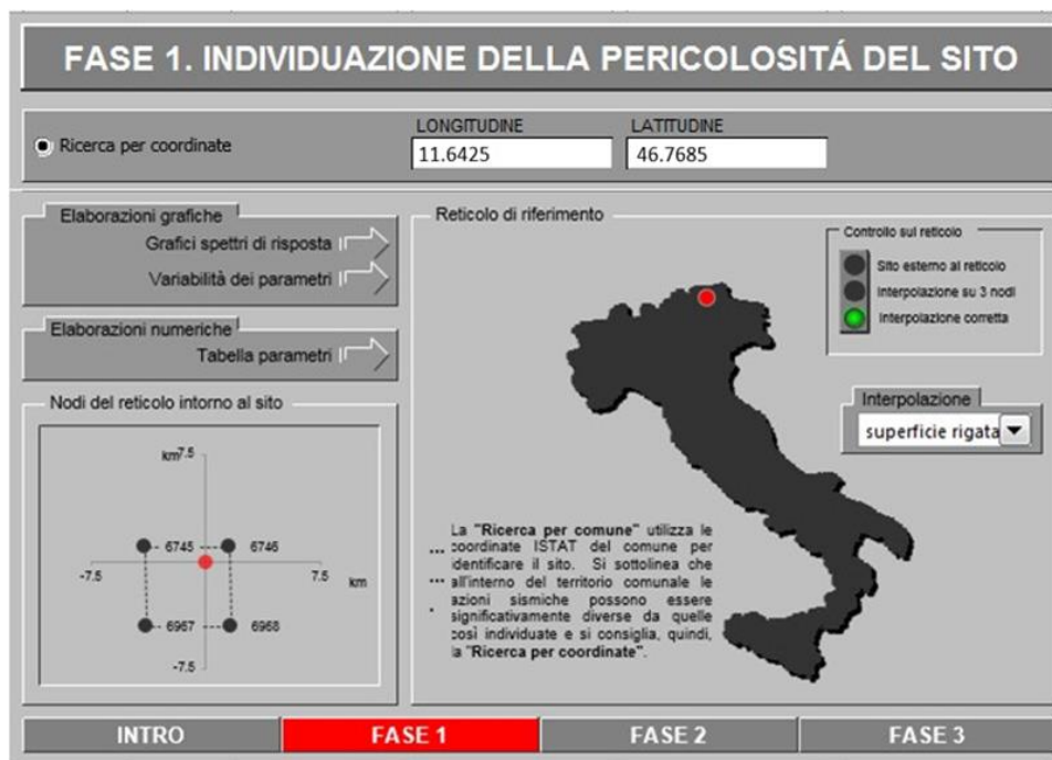
Figura 8-2: Associazione dei punti di interesse, ai nodi della griglia di rappresentazione dei valori di pericolosità sismica secondo le tabelle allegate alle NTC2008
