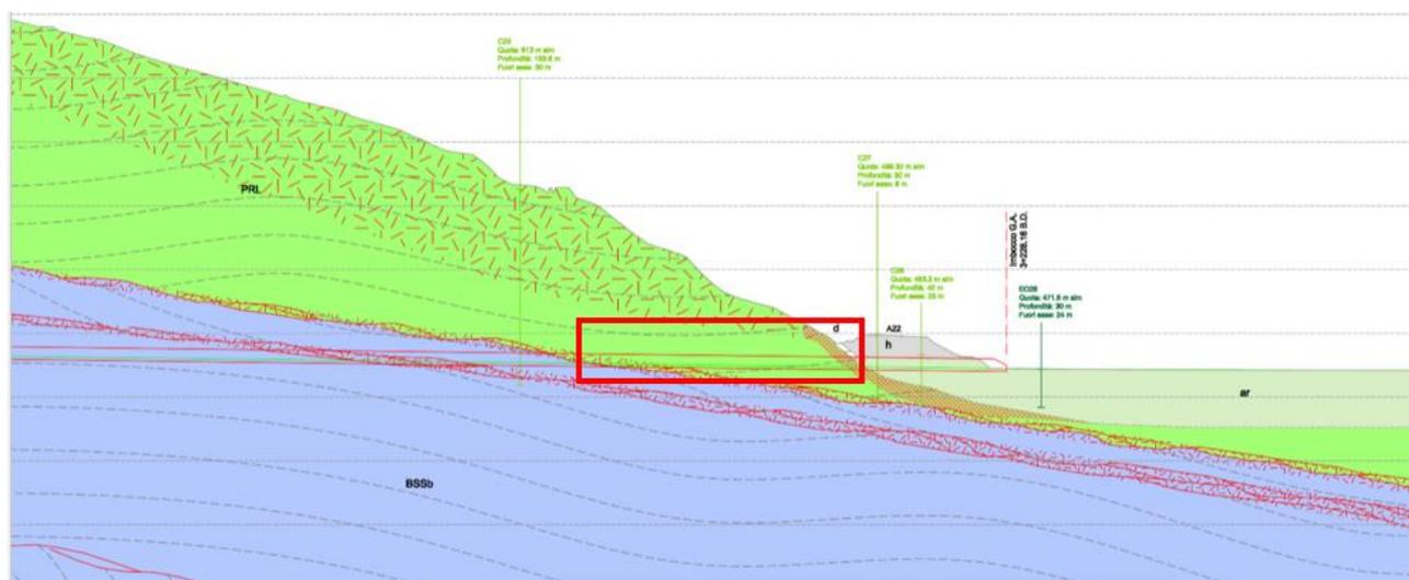
Fig. 74: Stralcio del profilo geologico dell'Interconnessione di Ponte Gardena B.D. (formazione PRL in evidenza)
