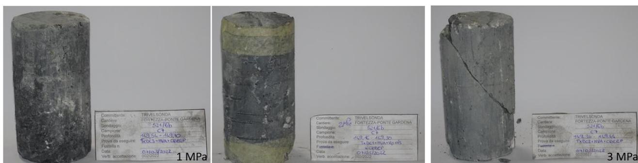
Fig. 57: Provini C7 prove di creep
