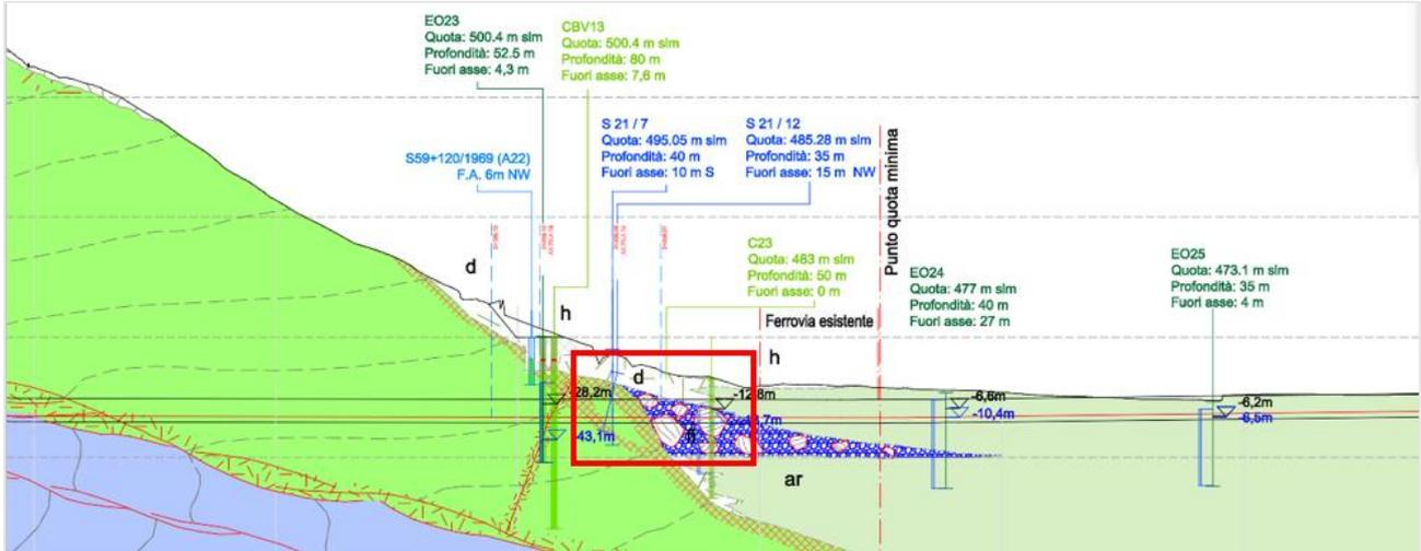
Fig. 28: Stralcio del profilo geologico dell'Interconnessione Binario Pari (rilevato autostradale in evidenza)
