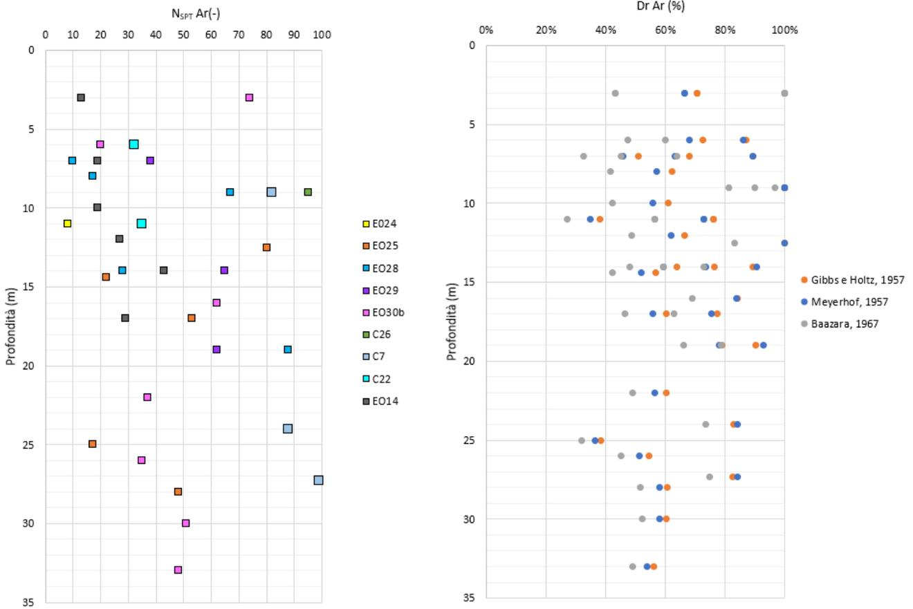
Fig. 35: ar – Depositi alluvionali recenti valori di  $N_{SPT}$  (a sinistra) e densità relativa da elaborazione  $N_{SPT}$  (a destra)
