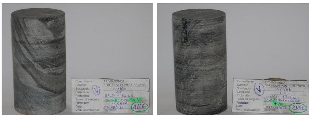
Fig. 56: Provini C2 prove di creep
