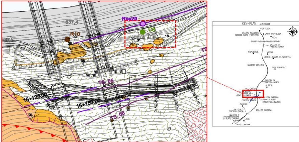
Fig. 16: Plano-profilo geologico di dettaglio Imbocco Nord Galleria Gardena – sondaggio C8 in evidenza
