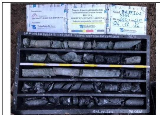
Roccia fratturata e tettonizzata di colore grigio con noduli di quarzo e vene ripiegate di dimensioni centimetriche con evidente dislocazione/deformazione; da 41,50 a 41,80 m e da 42,80 a 43,0 m materiale fine di colore nerastro.
