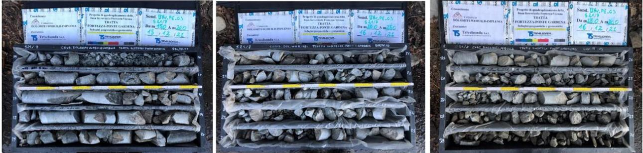
Fig. 96: Carote sondaggio S21/7 – da 15 m a 30 m
