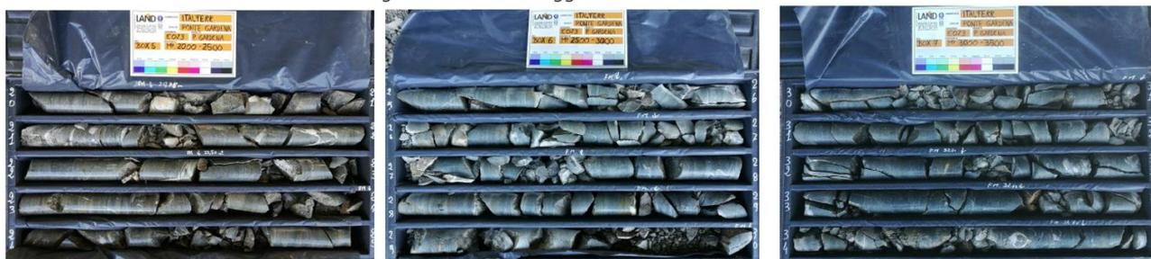
Fig. 84: Carote sondaggio EO23 – da 20 m a 35 m
