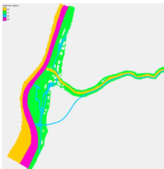
Figura 16 – Mappatura delle scabrezze utilizzate per le simulazioni idrauliche a Ponte Gardena per il Rio Gardena (PZP Comune di Ponte Gardena, aggiornamento 2017).
